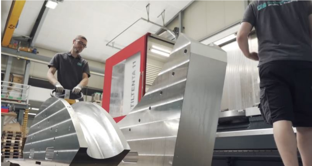
Bild 5: Die große Rohrbiegeform war eins der ersten auf der TILTENTA 11 gefrästen Werkstücke.
