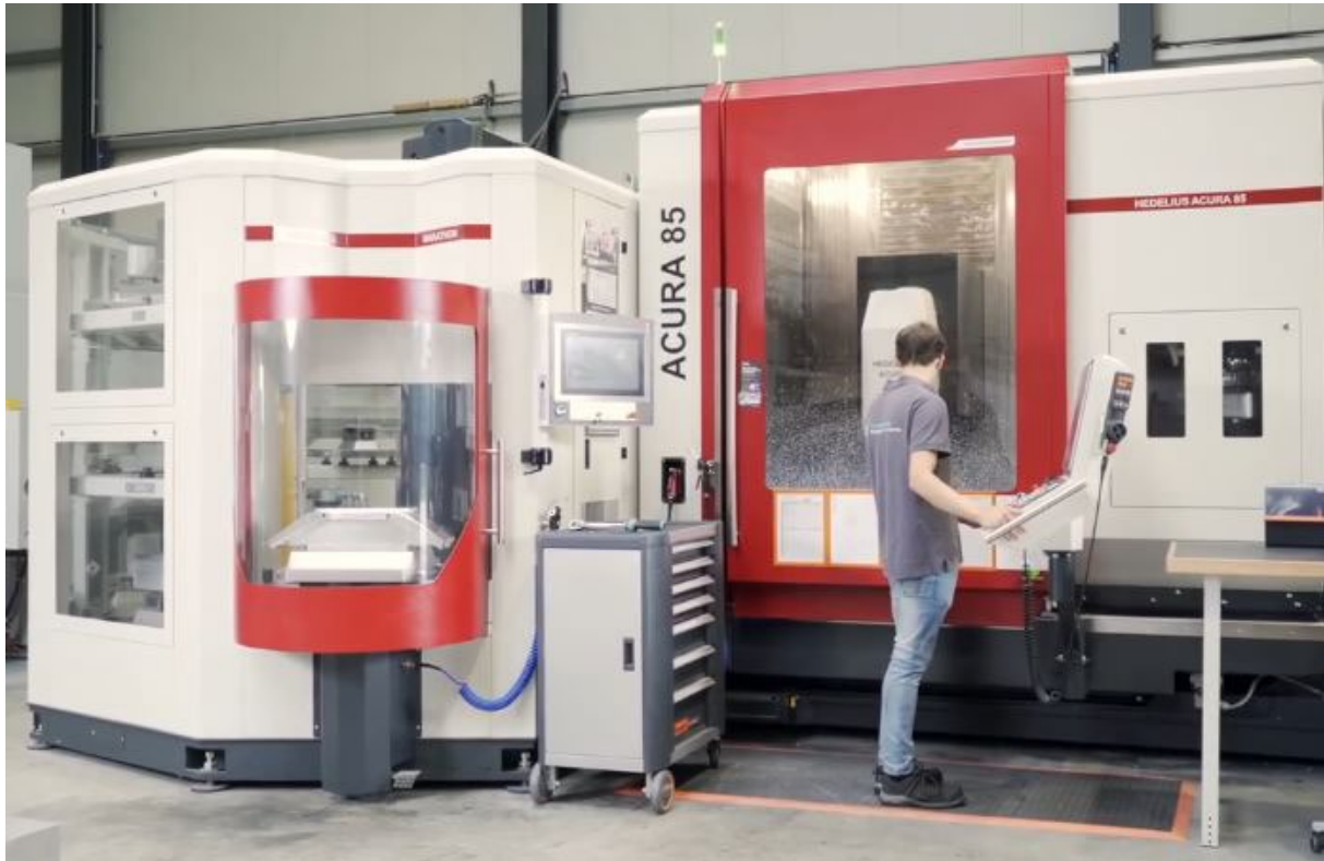
Bild 1: Auf dem automatisierten Bearbeitungszentrum ACURA 85 MARATHON werden im Lohnfertigungsbetrieb Carstengerdes viele unterschiedliche Bauteile für den Maschinenbau, die Luftfahrtindustrie und andere Branchen bearbeitet.
