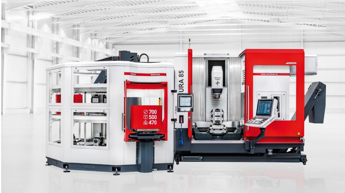
Bild 2: Große Werkstücke automatisiert fertigen – das ermöglicht die ACURA 85 mit angebundenem 18-fach Palettenspeicher MARATHON SR518.
