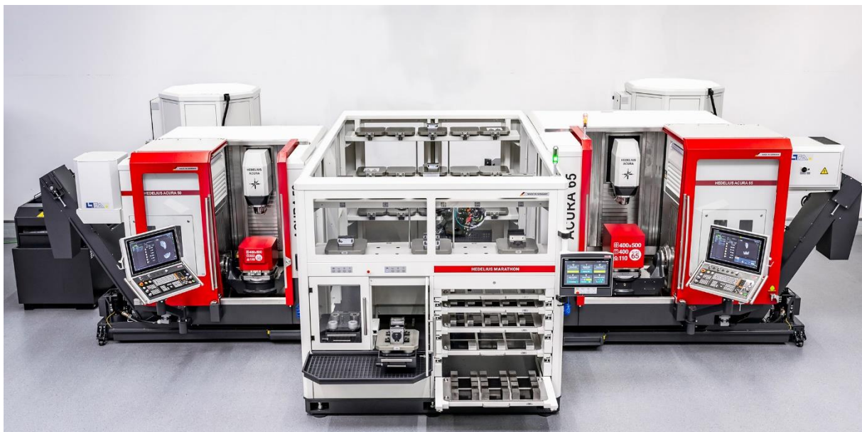
Bild 1: Premiere auf der AMB 2024: Die neue Hybridautomation MARATHON RZ430 kombiniert Paletten- und Werkstückbeladung und wird vor Ort gleich zwei ACURA 5-Achs-Bearbeitungszentren beladen.
