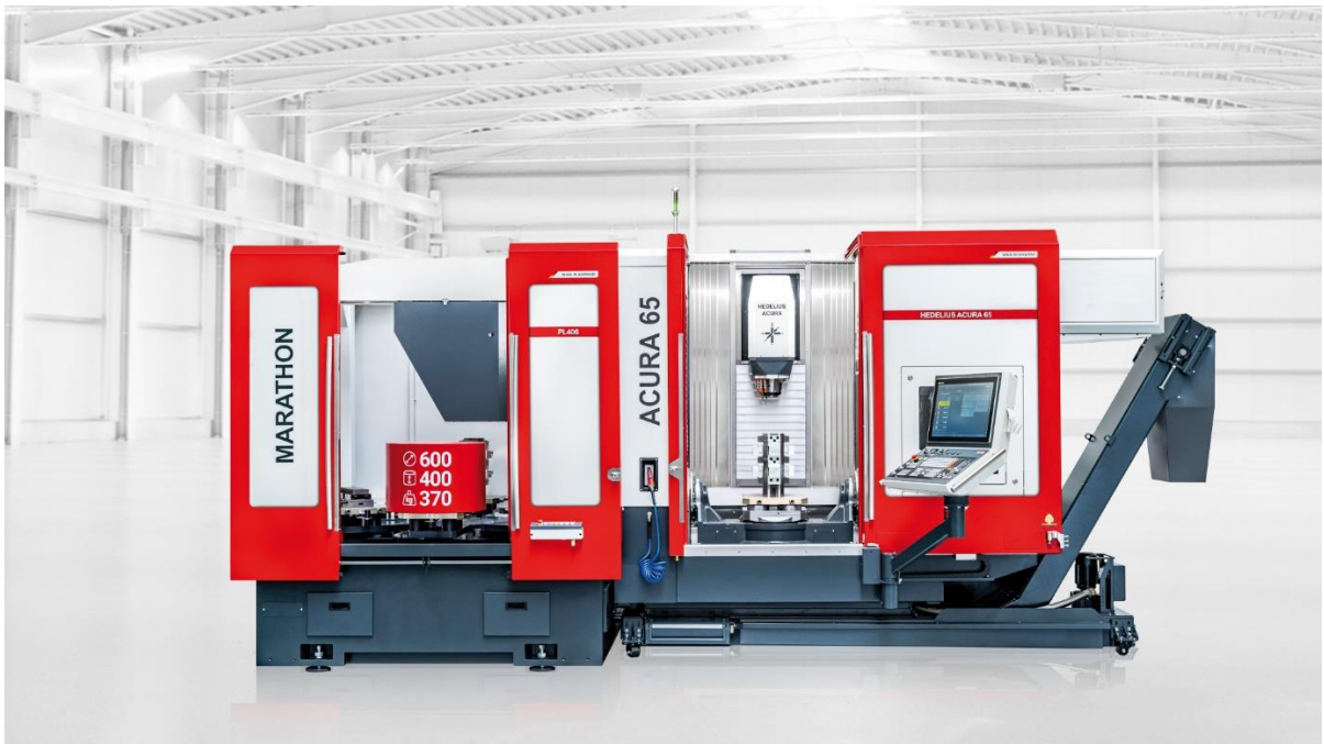
Bild 3: Mit der ACURA 65 und dem 6-fach Palettenspeicher MARATHON PL406 bietet HEDELIUS eine besonders kompakte Automationslösung für Betriebe mit begrenztem Platzangebot.
