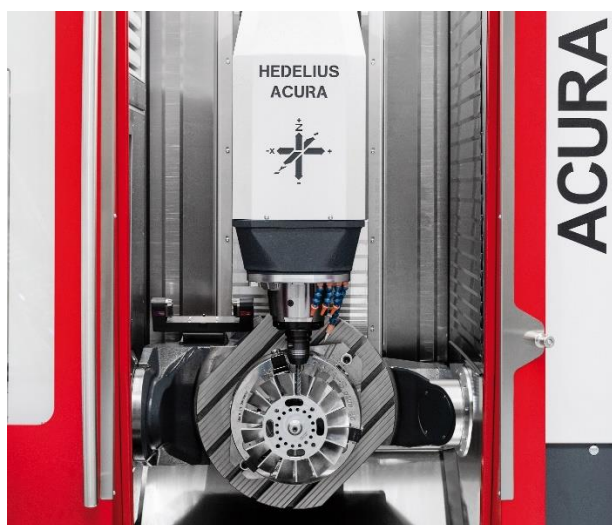
Bild 2: Um auch bei schweren Werkstücken und der Schruppbearbeitung höchste Stabilität zu gewährleisten, wird der Dreh-Schwenktisch in der ACURA Baureihe beidseitig hydraulisch geklemmt.
